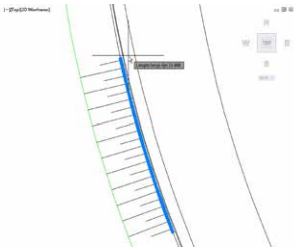
Taludarcering plaatsen met InfraCAD.
